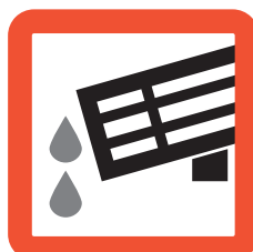
Při skladování vyspádovat pro odtékání vody
