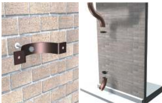
Obr. 19 – montáž objímek svodu
